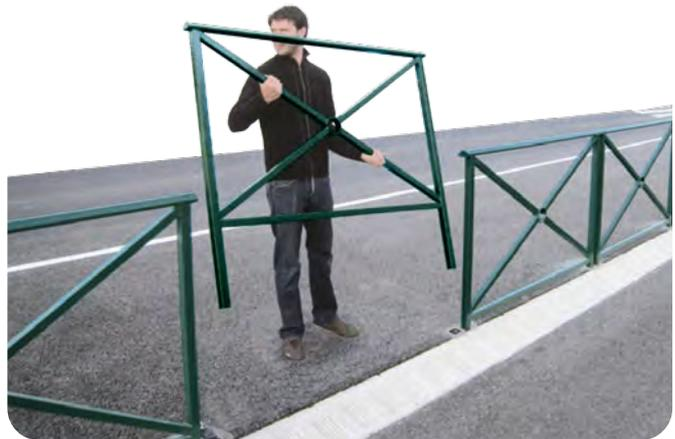
Toutes ces barrières de ville peuvent être rendues amovibles grâce à un kit d'amovibilité composé de 2 fourreaux dont l'un est verrouillable par clé triangle ; avec obturateur fixe pour sécuriser les trous lorsque les barrières ne sont pas en place ; avec réserve pour l'accumulation de sable et de poussières ; avec serrure protégée par cache basculant laqué noir.
