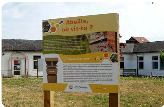
**Le HPL est particulièrement adapté à la signalisation didactique et touristique. Résistant aux intempéries, aux UV et au feu, ce matériau se montre également facile à nettoyer en cas de graffitis. De plus, l'impression étant réalisée dans la masse, les informations restent bien visibles, même en cas de griffes !**
