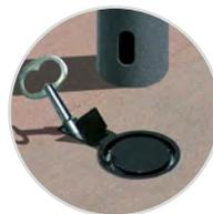
Peuvent être rendues amovibles grâce à un kit d'amovibilité composé de 2 fourreaux dont l'un est verrouillable par clé triangle ; avec obturateur fixe pour sécuriser les trous lorsque les barrières ne sont pas en place ; avec réserve pour l'accumulation de sable et de poussières ; avec serrure protégée par cache basculant laqué noir.
