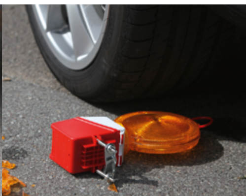
Test de résistance à l'écrasement d'un produit Nissen
