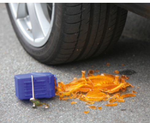
Test de résistance à l'écrasement d'un produit bas de gamme
