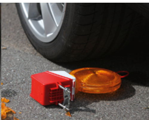
Test de résistance à l'écrasement d'un produit Nissen
